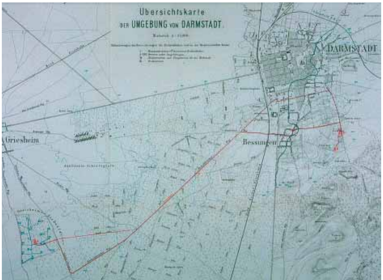
Übersichtskarte der Umgebung von Darmstadt mit der Darstellung der Wasserleitung aus dem Griesheimer Eichwäldchen
