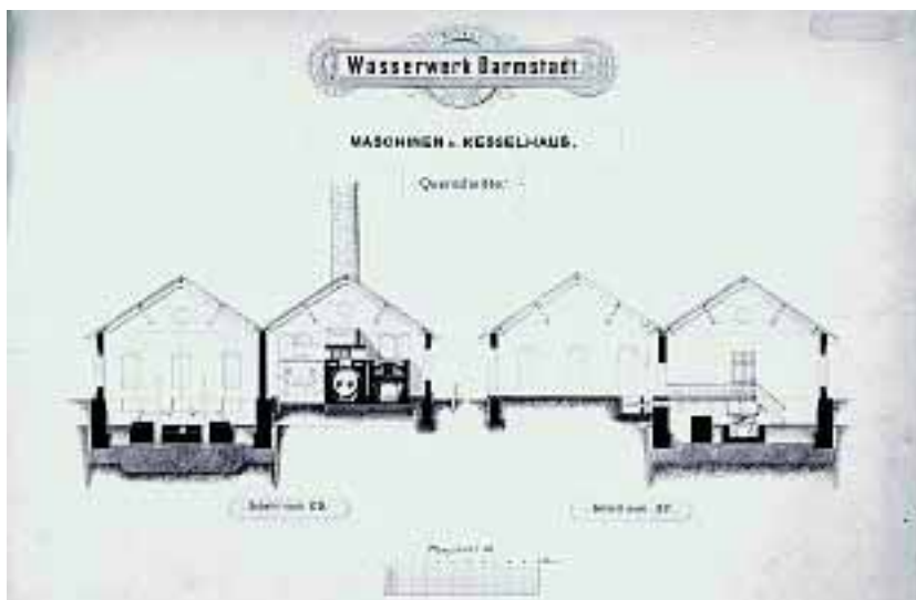
Querschnitte durch Maschinen- und Kesselhaus, Ausführungsplan 1879
